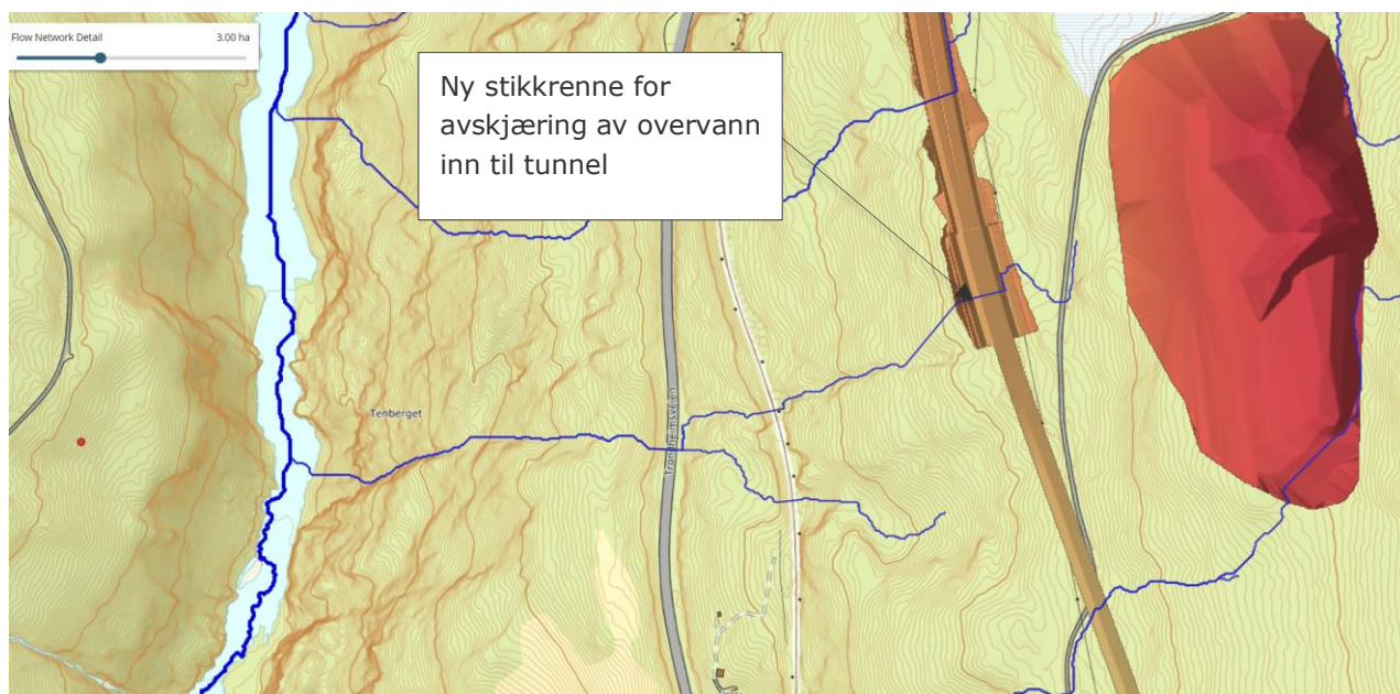
Figur 7-2. Avrenningsanalyse som viser avrenningslinjer inn mot tunnel.
