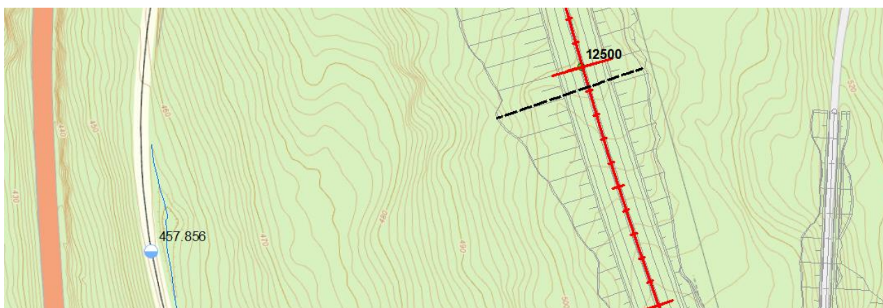
Figur 5-116. Forslag til plassering av ny kulvert, både for ny hovedvei/E6, ved p12500.
