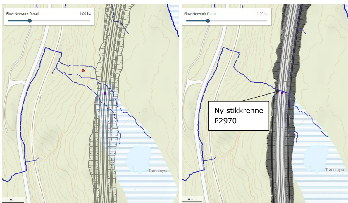
Figur 5-122. Avrenningsanalyse av dagens situasjon (venstre) og planlagt situasjon (høyre) med stikkrenne under ny E6.
