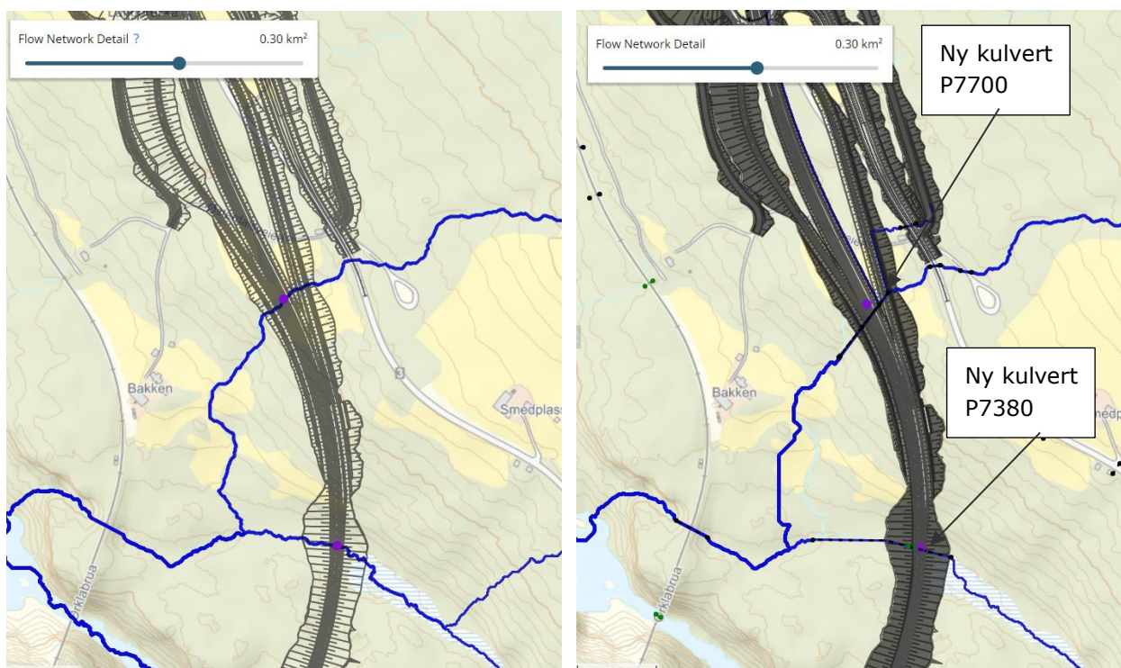
Figur 5-57. Avrenningsanalyse av dagens situasjon (venstre) og planlagt situasjon (høyre) med kulverter under ny E6.
