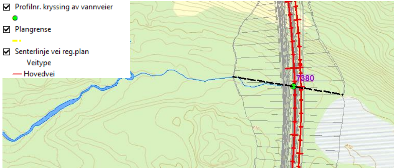
Figur 5-55. Forslag til plassering av ny kulvert.
