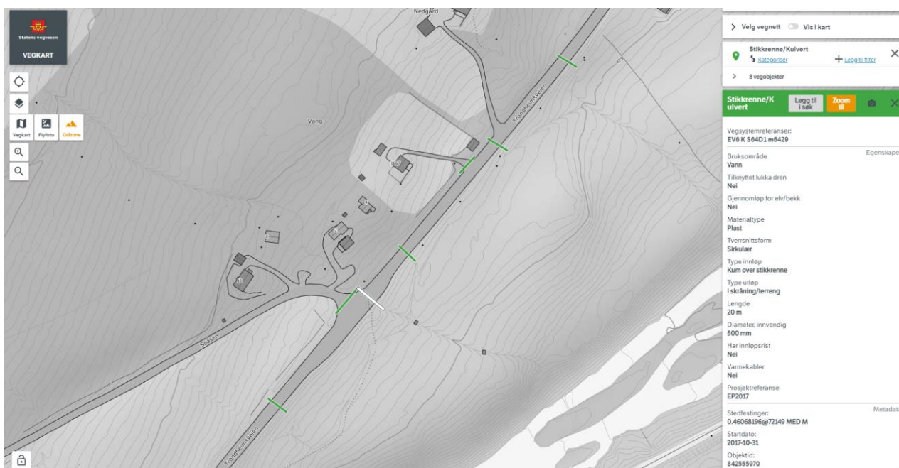
Figur 5-3. Informasjon eks. stikkrenne ved p2970. Kilde: Vegkart.
