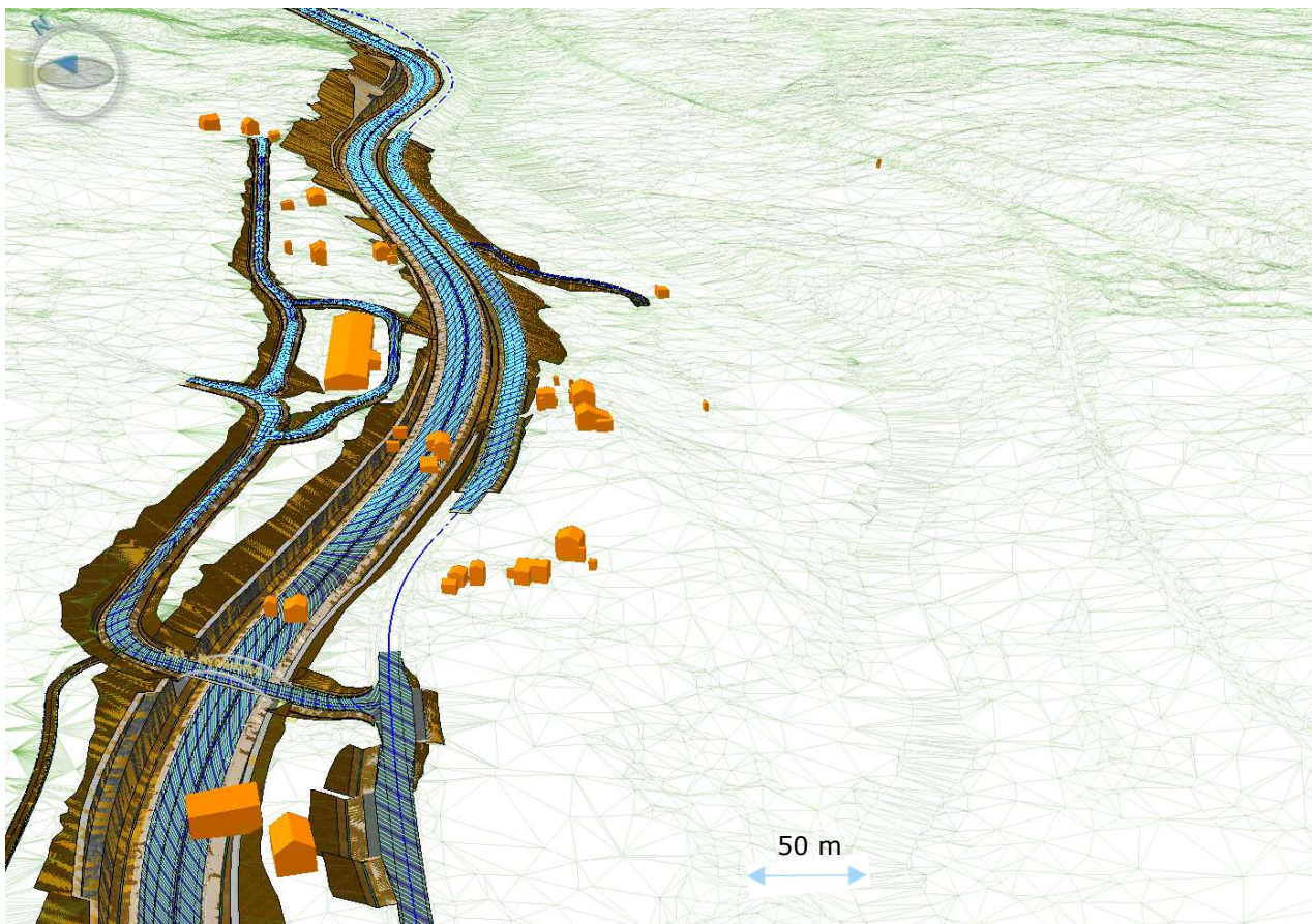
Figur 26 Bygninger langs linjen 4900 – 5900 nærmere enn 100 m.
